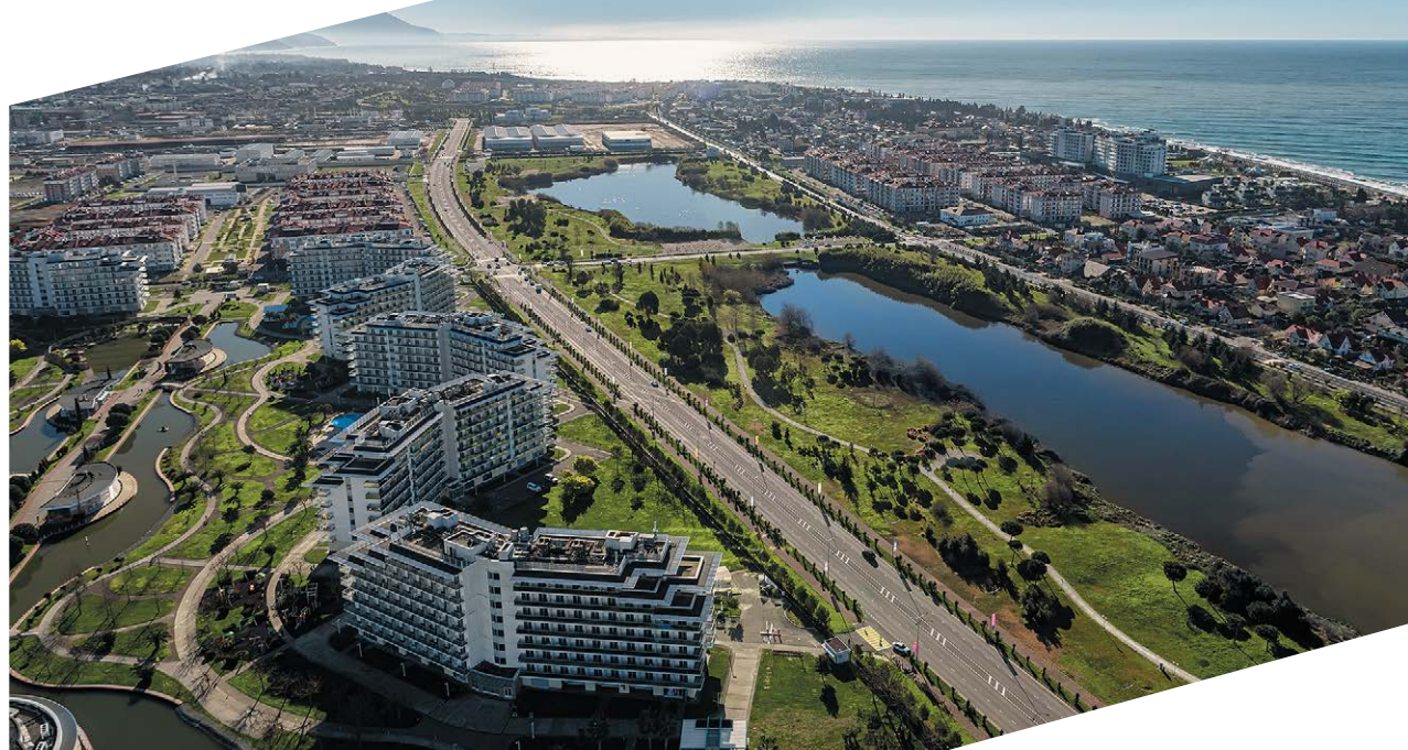
Водоёмы Сириуса позволяют регулировать уровень воды в системе ливневой канализации
